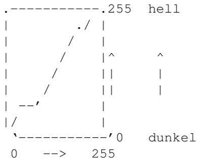
Das nebenstehende Diagramm zeigt eine Farbkorrekturkurve. Alle Scanner unterstützen eine Einteilung der Helligkeit in 256 Stufen. Diese Einteilung ist für jede Farbkomponente gültig.
